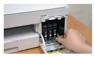
②カートリッジのロックが外れますので、 手前に引き出して外します。
