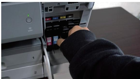
②カートリッジのロックが外れますので、手前に引き出して外します。
