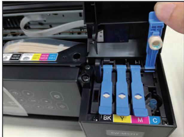
**④ボトルの先端（ノズル部分）をインクの注入口に
