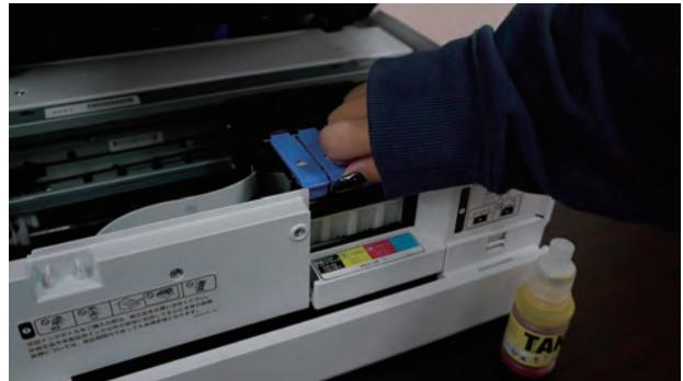
④ボトルの先端（ノズル部分）をインクの注入口に
