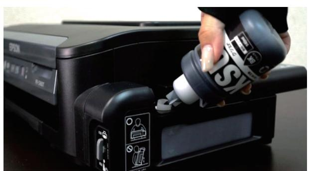
⑥タンクキャップを確実に閉め、タンクカバーを閉めれば、補充完了です。
