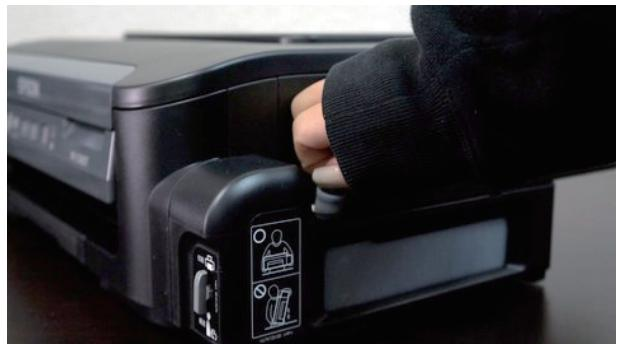
④ボトルの先端（ノズル部分）をインクの注入口に沿わせます。
